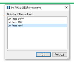
注意: なお、出力可能な JetPress は、予め XMF 側で Configuration Tool を使用して登録しておく必要が有ります。 Switch 上では、その登録名を XMF から取得しリストに表示します。JetPress 機種登録方法の詳細については、 XMFInstall ガイドの Configuration Tool で JetPress の設定を参照ください。
