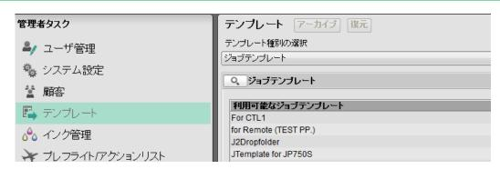
3. 開いたテンプレートの「ワークフローマネージャ」ペイン上にある Press アイコンをクリックし、現れたデバイス情報アイコン(プリンタの絵)をクリックします。プレスプロファイルオプション中に表示された「プレスデバイスプロファイル」のプルダウンから、対象とする JetPress 機器を選択します。テンプレートを保存する際は、選択した機種が分かるような名前を付けてください。
